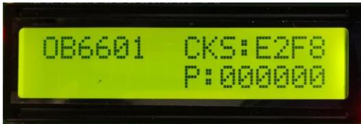
4) 如果下载的是加密代码，烧录器 LCD 显示芯片型号、校验和及允许烧录数量。
