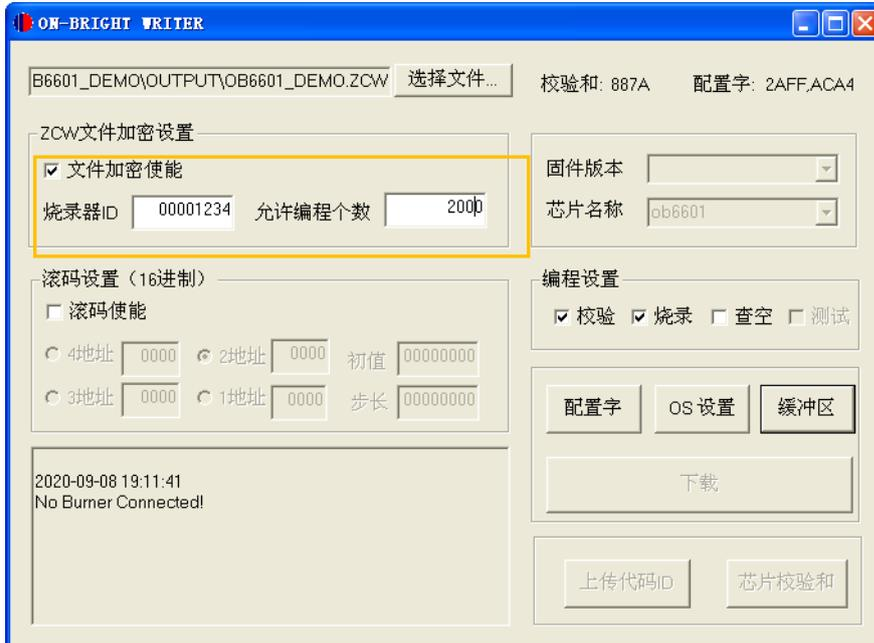
2) 允许编程个数内填入希望限制烧录的数量（10 进制格式）
